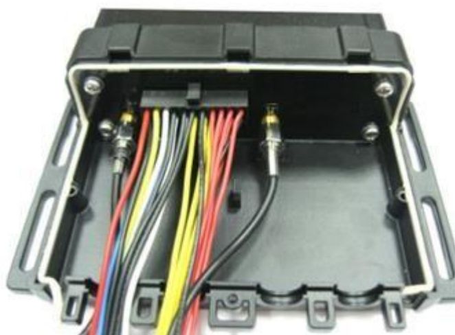
Рисунок 11 – установка уплотнительного жгута
