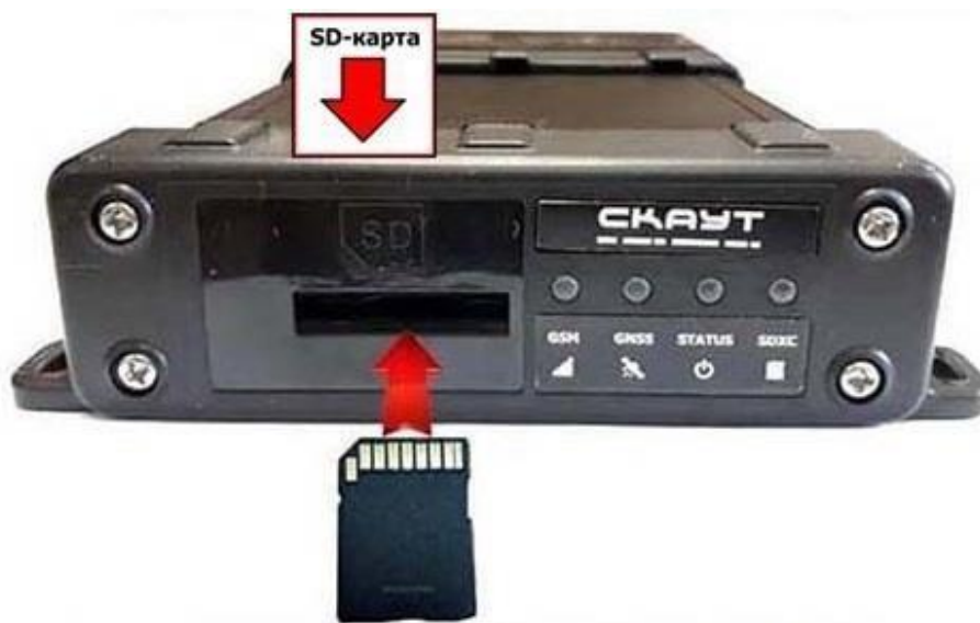
Рисунок 9. Установка SDXC-карты
