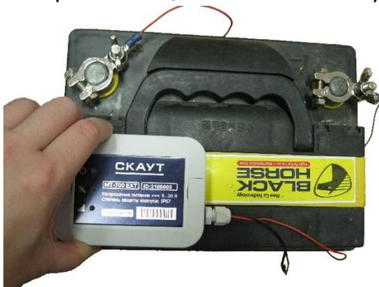
**Рисунок 7.** Наклеивание терминала на АКБ.
