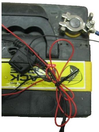
**Рисунок 10.** Крепление проводов с помощью стяжки.
