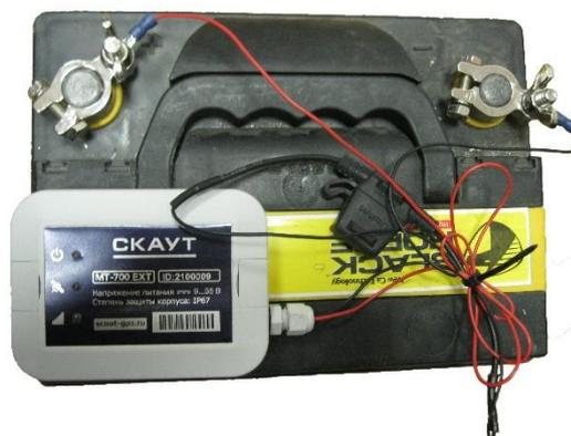
**Рисунок 8.** Установка MT-700 EXT с помощью скотча. Провода свернуть и закрепить стяжкой.
