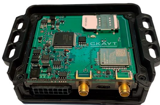
Рисунок 15. Терминал исполнения ENT без нижней части корпуса
