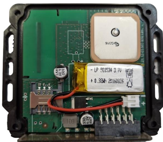
Рисунок 13. Подключение АКБ
