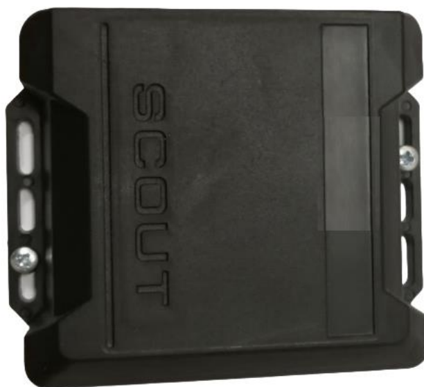
Рисунок 15. Крепление с помощью саморезов
