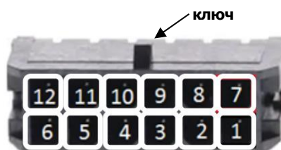
Рисунок 6. Интерфейсный разъем MT-900 One
