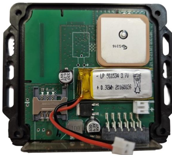
Рисунок 12. Фиксация АКБ скотчем
