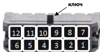
Рисунок 2. Интерфейсный разъем MT-900 LITECAN
